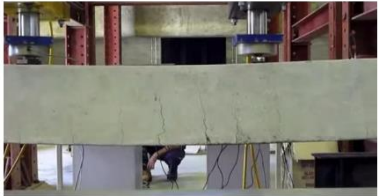
Ensaio de flexão em viga de concreto armado
