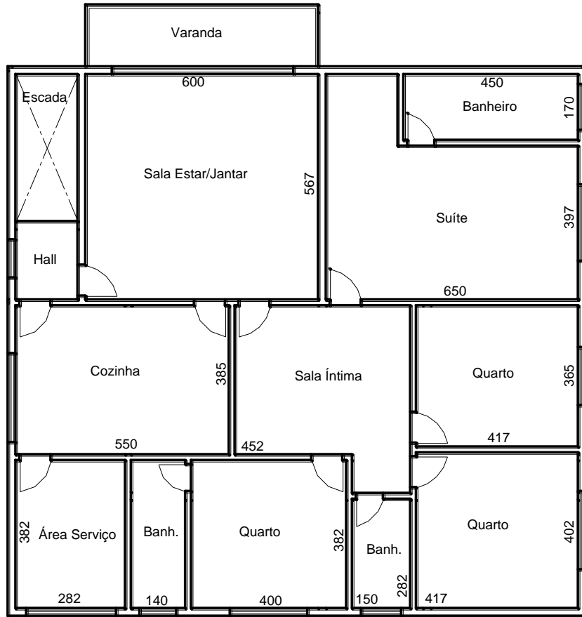
Figura 49 – Planta arquitetônica simplificada do pavimento.
