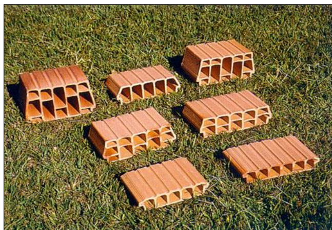
Figura 79 – Bloco cerâmico de enchimento (FAULIM, 1998).
