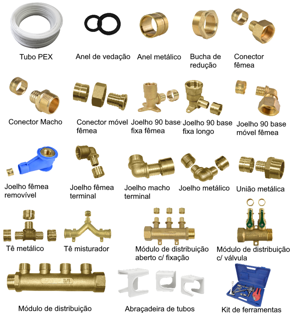
Figura 44 - Principais componentes da Linha PEX
