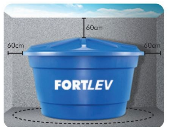
Figura 29 – Espaço para circulação ao redor do reservatório
